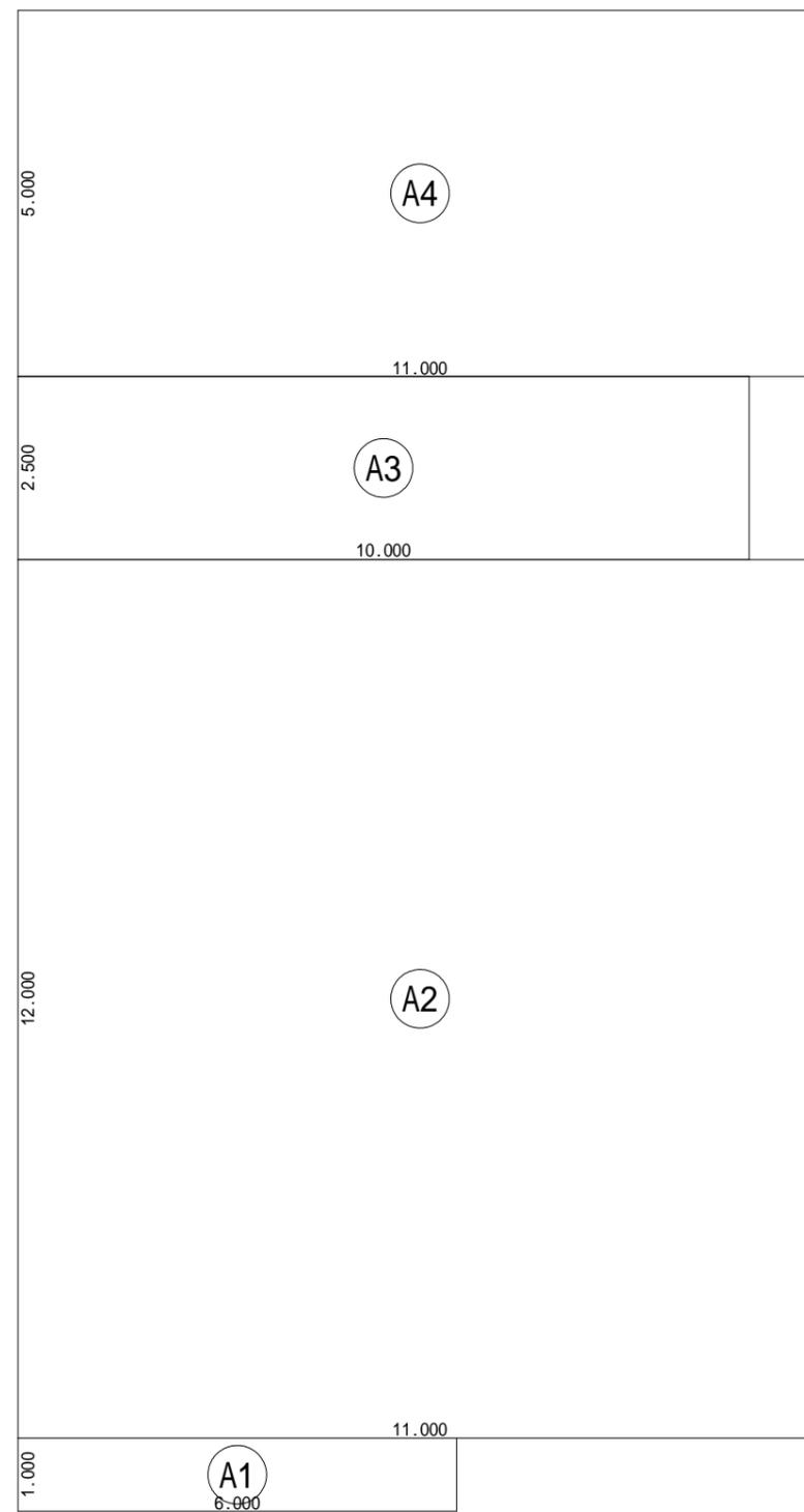
1階 床面積求積図 S:1/100
